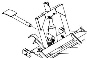
Figure 7: Assemblage de la pédale
