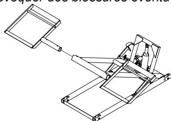
Figure 5: Fixation du support de roue
