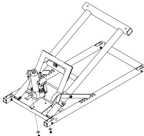
Figure 3 : Assemblage du cric-bouteille à la plate-forme
