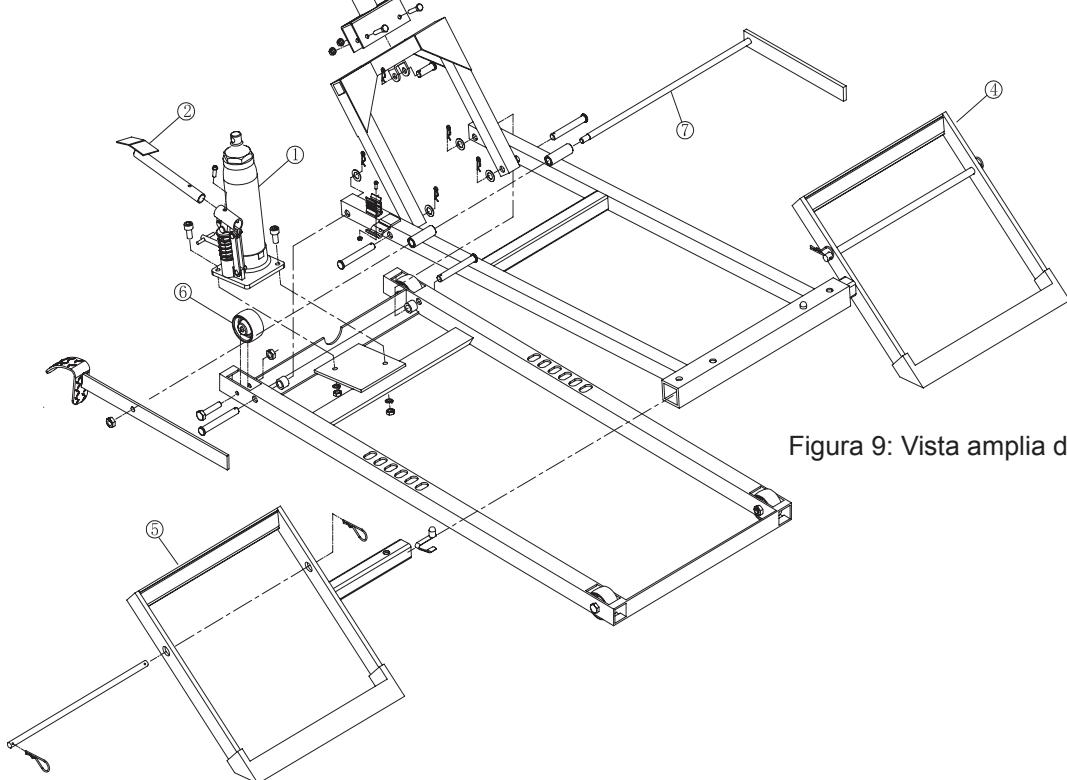
de estacionamiento del cortacésped, coloque la transmisión en punto muerto y retire los calzos con cuidado. Bombee el pedal de elevación varias veces para desacoplar las palancas de bloqueo de altura. Con cuidado, gire la válvula de liberación en el sentido contrario a las agujas del reloj, lentamente, pero no más de 1 vuelta desde la posición cerrada, para bajar la carga lenta y segura.
