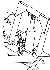
Figure 4: Insertion de la tige du cric-bouteille
