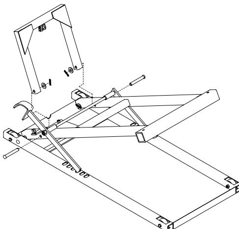
Figure 2 : Assemblage du support du pont élévateur
