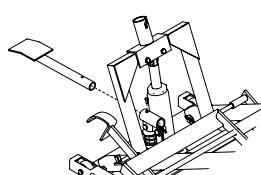
Figura 7: ensamblaje del pedal accionado por el pie.
